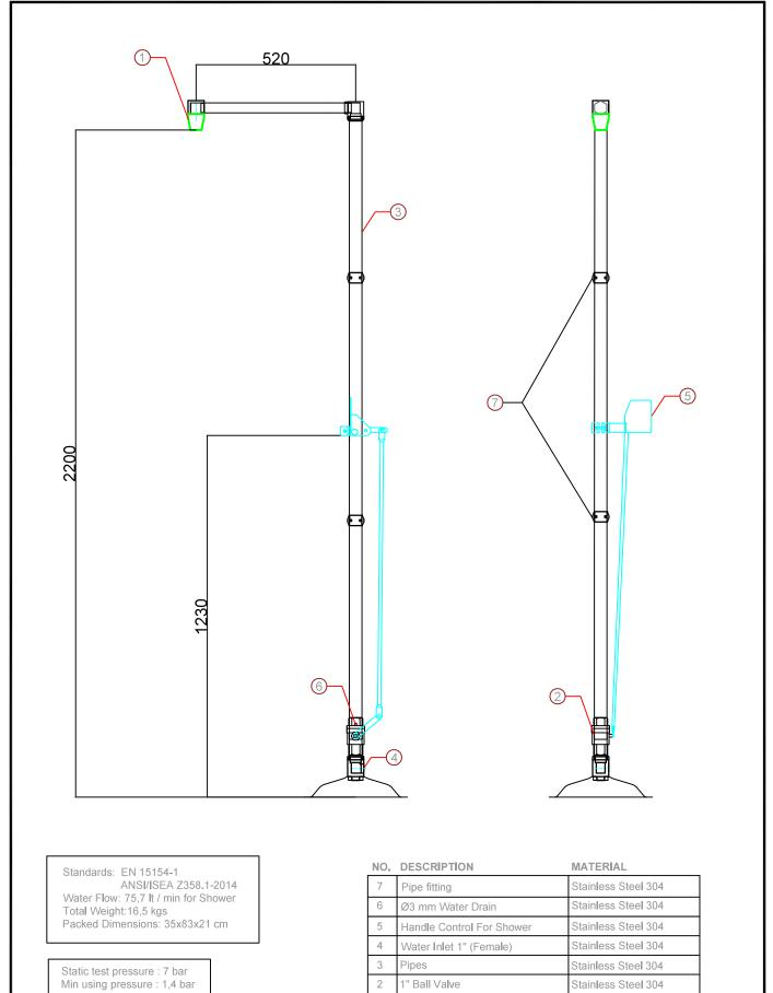
Min using pressure : 1,4 bar Max using pressure : 2,8 bar
